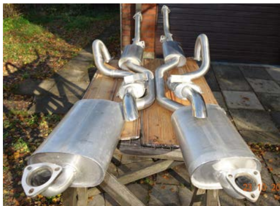
Pakoputket ruostumattomasta teräksestä.
