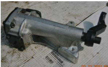
Ohjausvaihteen korjattu kotelo.
