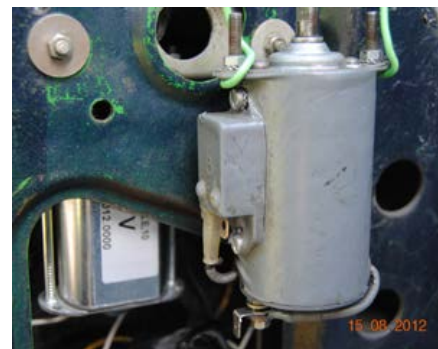
Oven ikkunan moottori, uusi paikallaan.
