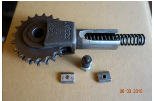
Nokka-akseliketjun kiristysmekanismi. Toinen lukituskappale tehty itse.
