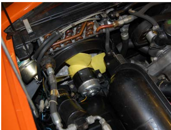
Ilmastointilaitteen kondensaattori ja tuuletin. Juhani Anttila
